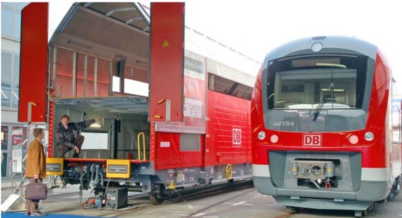
Abb. 1-8: Güterwagen für den Pkw-Transport und elektrischer Triebwagen für den Regionalverkehr
