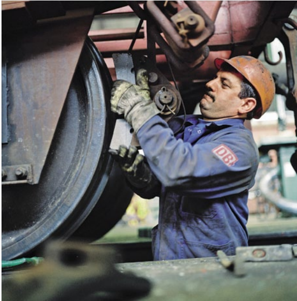
Abb. 142: Umrüstung der Güterwagenflotte mit Verbundstoffbremsklötzen als wichtiger Beitrag zur Lärminderung
