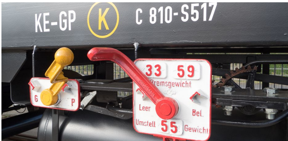
Abb. 10-1: Beim Feststellen des Zustands der Bremse wird unter anderem auch die richtige Einstellung der Umstelleinrichtungen geprüft.
