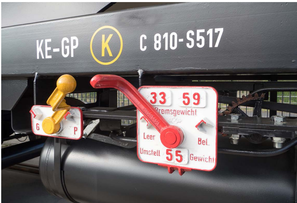
Abb. 6-4: Beim Feststellen des Zustandes der Bremse wird unter anderem auch die richtige Einstellung der Umstell-einrichtungen geprüft.
