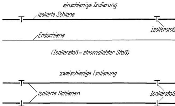
Bild 5 Ein- und zweischienige Isolierung
