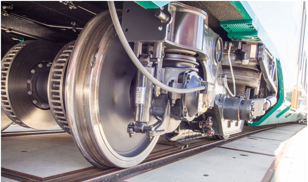
Abb. 1-16: Das Laufwerk übernimmt die Führung der Fahrzeuge im Gleis, die Übertragung der Last sowie deren Federung.
