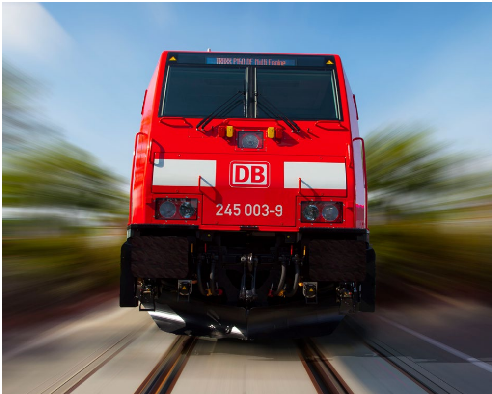
Abb. 1-1: Die DIN 25003 definiert Schienenfahrzeuge als spurgebundene Fahrzeuge, die von mit Spurkranz versehenen Rädern auf Gleisen einer bestimmten gleichbleibenden Spurweite geführt und getragen werden.
