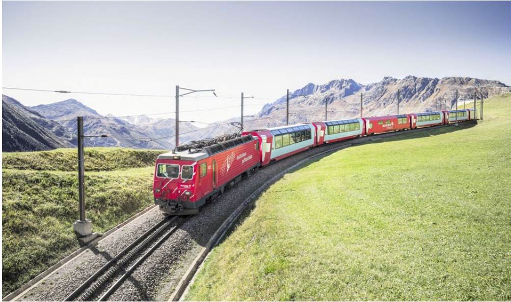
Abb. 1-25: Schmalspurige Matterhorn-Gotthard-Bahn (Schweiz) mit einer Spurweite von 1.000 mm. Die im Gleis angeordnete Zahnstange dient dem Zahnradbetrieb (siehe Kapitel 9.2.1).
