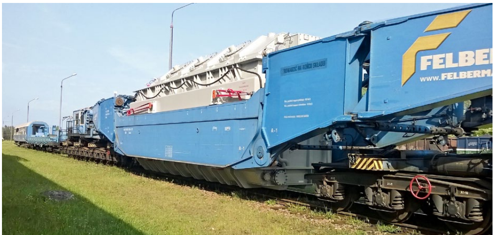
Abb. 1-31: Lademaßüberschreitung: Transport auf einem Tiefladewagen der Bauart Uai
