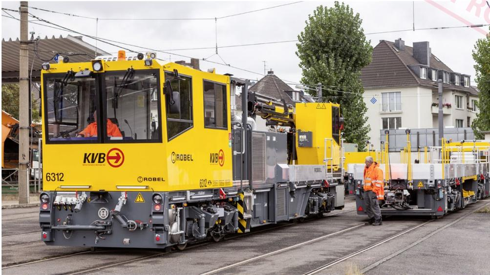
Abb. 1-8: Gleiskraftwagen für die Wartung und Instandhaltung von Bahnanlagen
