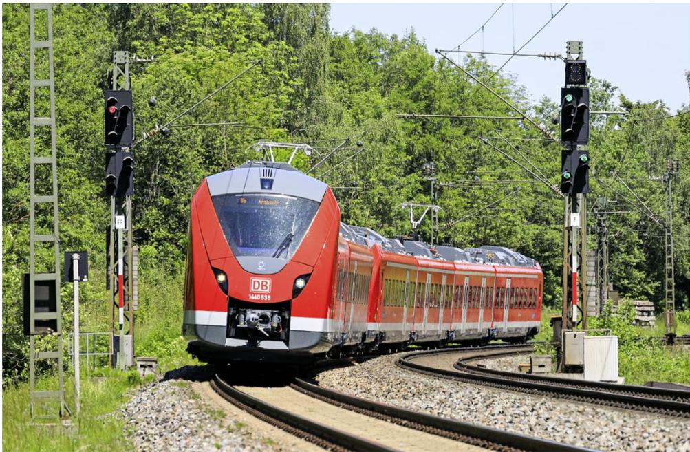
Abb. 5-1: Ortsfeste Signale übermitteln die Fahr- und Haltbefehle optisch an den Triebfahrzeugführer.
