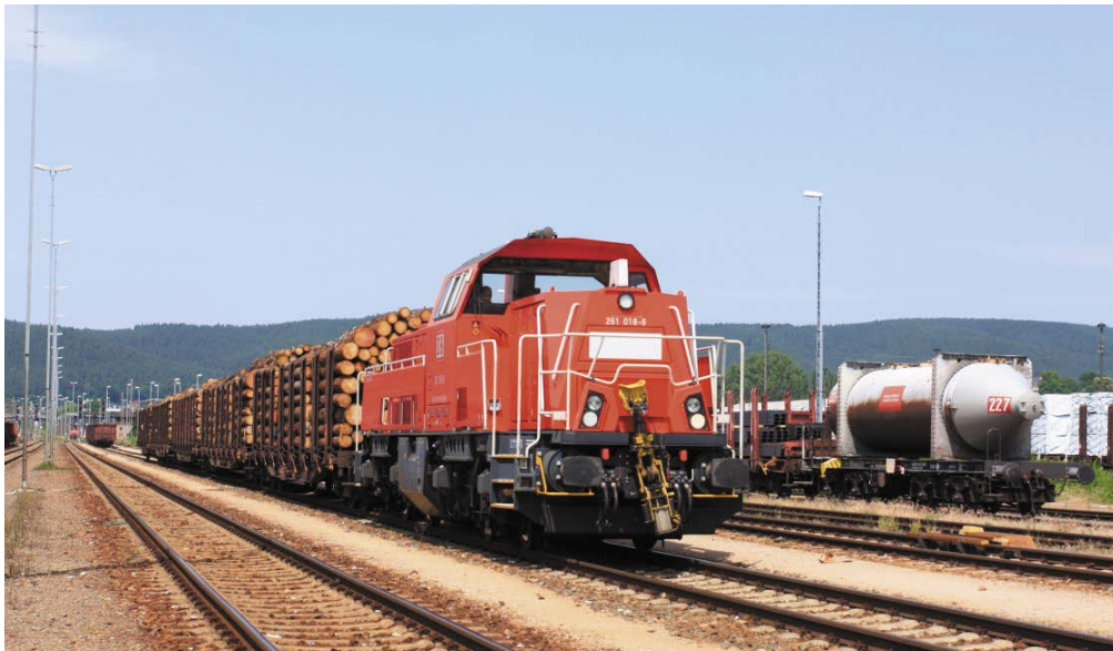
Abb. 1-1: Aus Einzelfahrzeugen gebildete Güter- und Reisezüge sind mit einer durchgehenden Druckluftbremse ausgerüstet.
